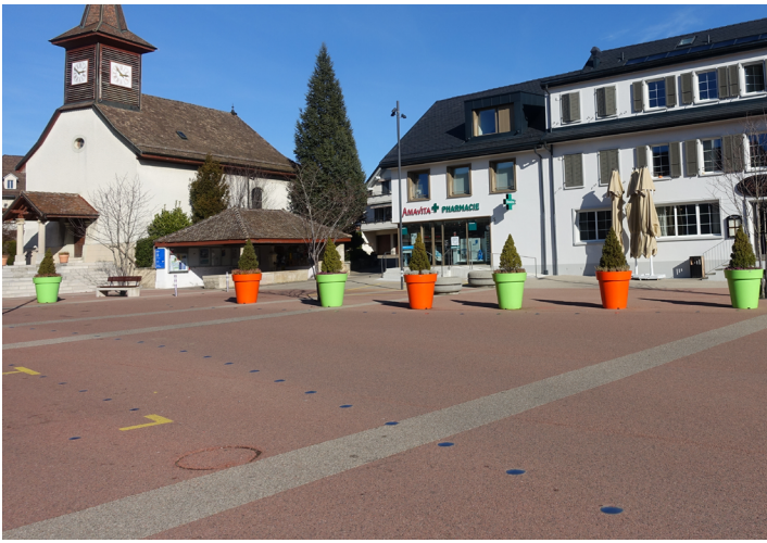
Der Kanton verweigerte die Genehmigung für Tempo 30 wegen des fehlenden Höhenunterschieds zwischen der Fahrbahn und den Bereichen für Fussgängerinnen und Fussgänger. Stattdessen genehmigte er Tempo 20.
