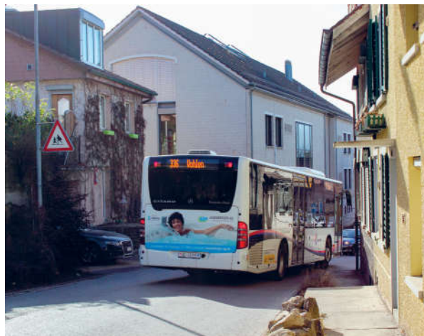
Die enge Stelle am Eingang zum Ortskern erschwert das Kreuzen, was den Verkehr durchs Dorf ein bisschen beruhigt. Foto: R. Rieder, EspaceSuisse
